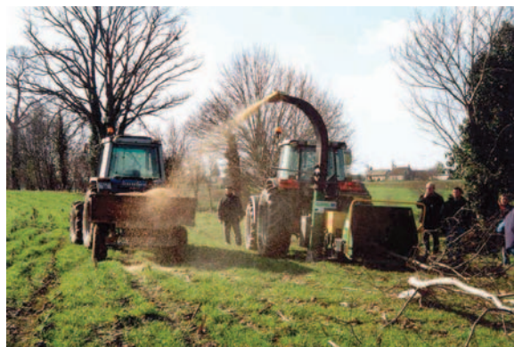
Opération de déchipetage permettant de transformer le bois en plaquettes
